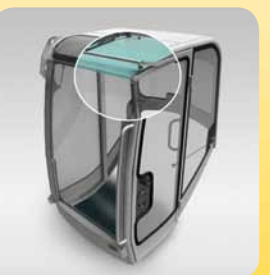
4 Оба стекла сдвинуты и размещены под крышей в кабине. Нет необходимости их снимать или хранить в каком-то другом месте. Это снижает риск их повреждения.
