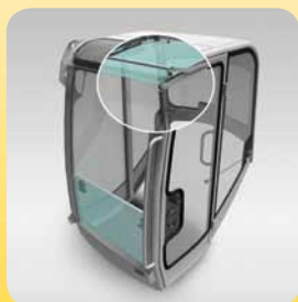
2 Сдвижная верхняя часть просто перемещается под крышу кабины. Там она в безопасности.
