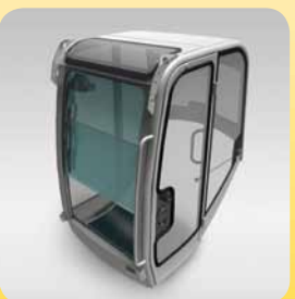
3 Положение для переговоров: Нижняя часть стекла сдвигается под верхнюю. Это позволяет общаться оператору с людьми вне кабины.
