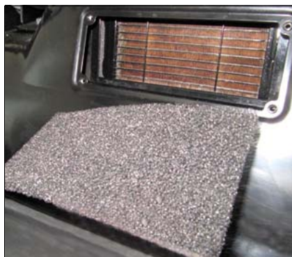
Рис. 264: Установить фильтр свежего воздуха
