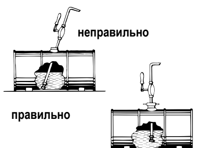
Рис. 105: Заправка топливом из бочки
