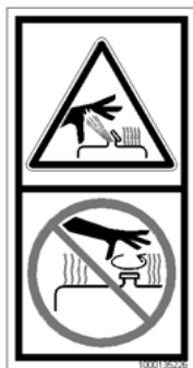
Рис. 16: Гидравлический бак находится под давлением
