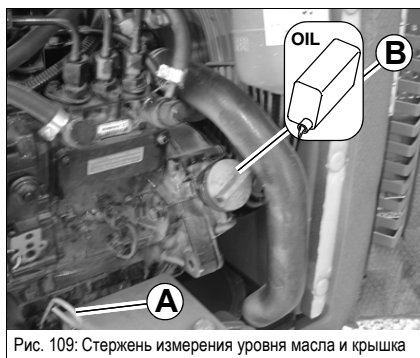
Рис. 109: Стержень измерения уровня масла и крышка
