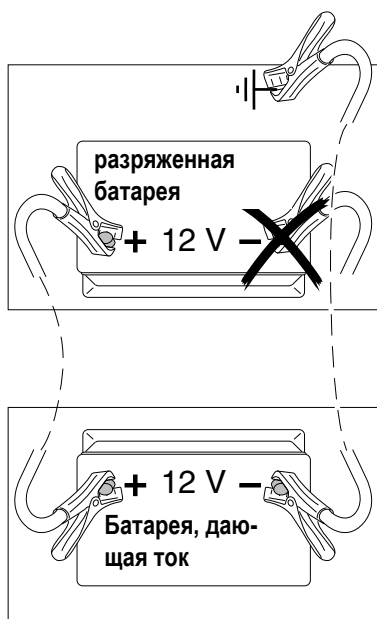
Рис. 42: Облегчение пуска с помощью кабельной пере- мычки
