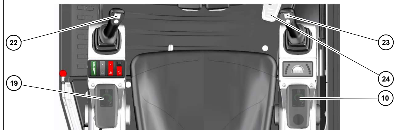
Рис. 104: Обзор элементов управления - пропорциональное управление
